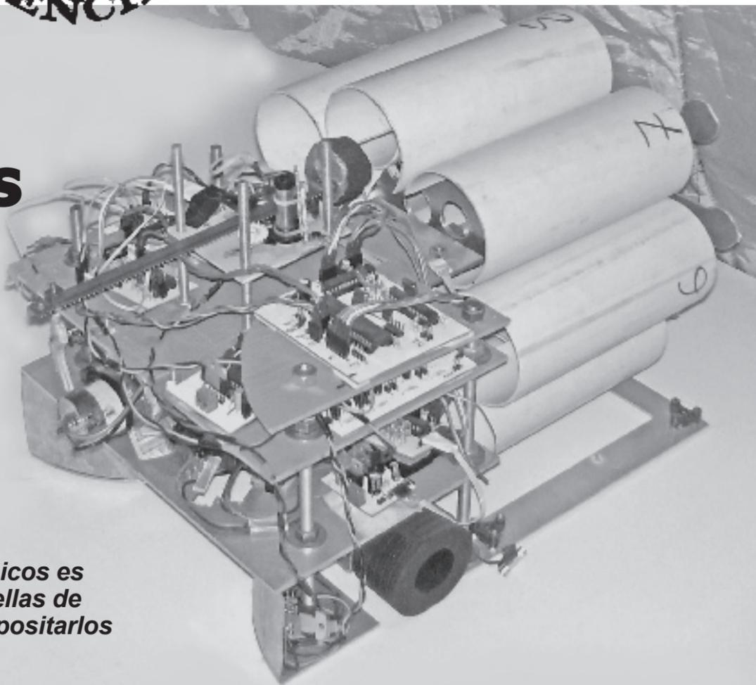
● **El robot construido por los jóvenes politécnicos es capaz de recoger residuos sólidos (latas, botellas de medio litro y pilas tipo "D"), clasificarlos y depositarlos en contenedores**
