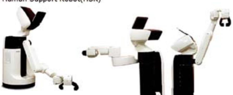
El HSR operable por comando de voz, PC o tableta, tiene un muy maniobrable, compacto y ligero cuerpo cilíndrico con un brazo plegable que permite tomar objetos del piso, succionar objetos delgados, recobrar objetos de lugares altos, abrir cortinas y realizar otras tareas de la casa.
