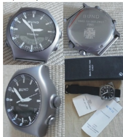
Como curiosidad decir que agujas e índices no llevan ningún material luminescente...La pantalla digital lleva retroiluminación accionada por el pulsador de arriba a la izquierda y en ella se pueden mostrar todos los datos necesarios para el soldado.
